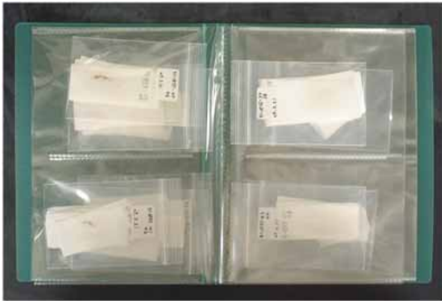
図7 保存シートに貼り付けた切片の保管例 チャック付きの小袋に入れた切片をアルバムにまとめて管理し、 4 で保存している。
